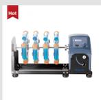
> Miscelatore rotante verticale a velocità regolabile 10-70rpm, operatività continua e a tempo 1-1199min., display LCD
