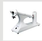
> Polarimetro a disco, Lampada LED, lunghezza d'onda 589.44nm, misurazione -180° - +180°
