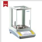
> Bilancia elettronica di alta precisione, rilevazione automatica dei guasti, calibrazione lineare a quattro punti, ampio display LCD, interfaccia RS232C, funzioni di conteggio automatico e conversione unità, capacità 0-200g
